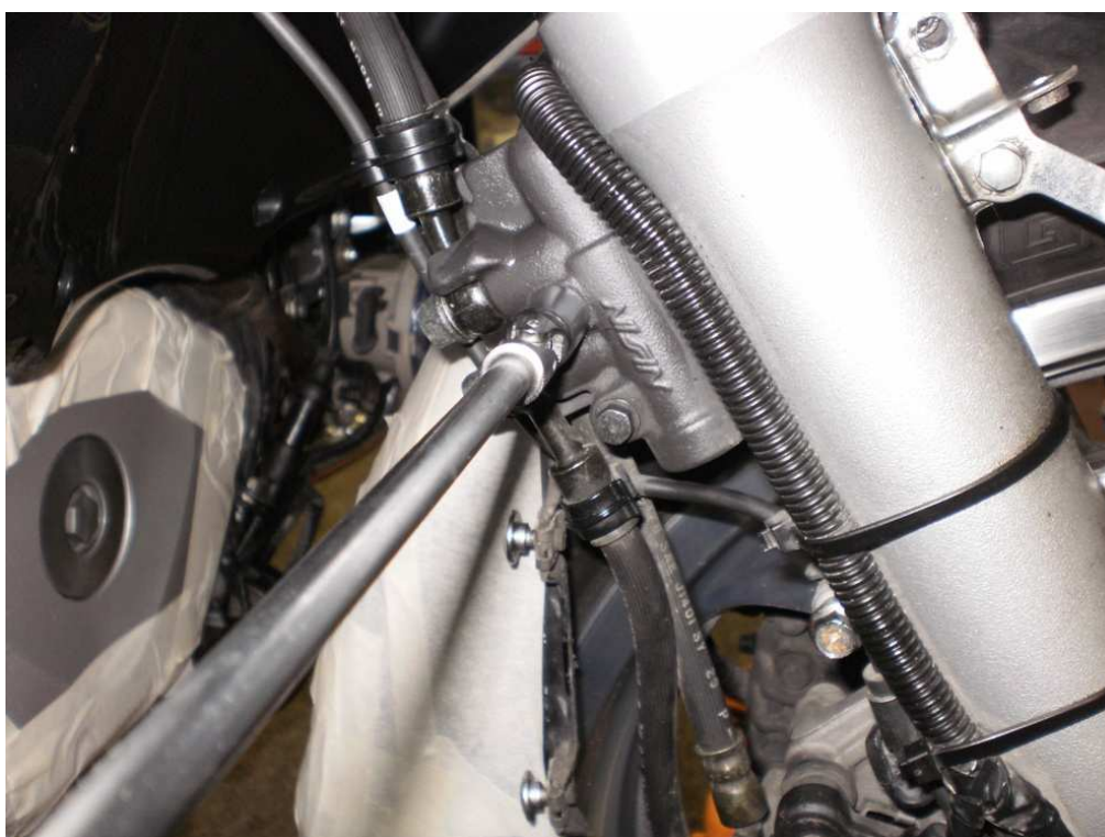
Demontáž zadního šroubu blatníku na levé straně.
