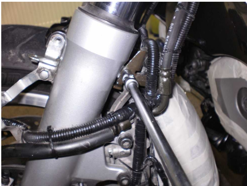
Demontáž levého zadního šroubu blatníku.
